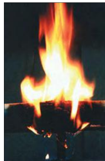
Mancata espansione del prodotto installato in ambiente umido
