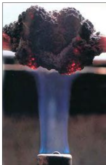
Corretta espansione del prodotto installato in ambiente asciutto
