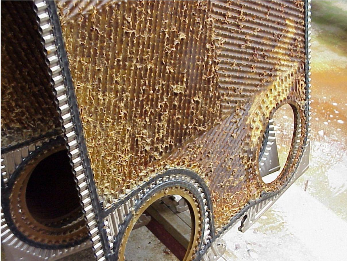
Scambiatore a piastre potrebbe sporcarsi notevolmente e ridurre l'efficienza della macchina e la vita utile del componente.
