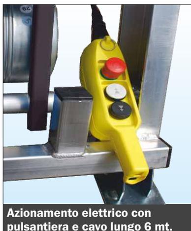
**Azionamento elettrico con pulsantiera e cavo lungo 6 mt.**
