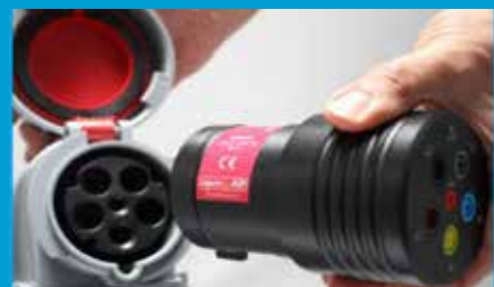
AS50/CEE5PXXA Adattatore per misure su prese CEE 5 poli, disponibili in 3 formati: 16A, 32A, 63A. Tramite questi adattatori è possibile connettere i terminali di prova dello strumento con banana 4mm ad una presa interbloccata in modo veloce e sicuro, evitando lo smontaggio della presa.
