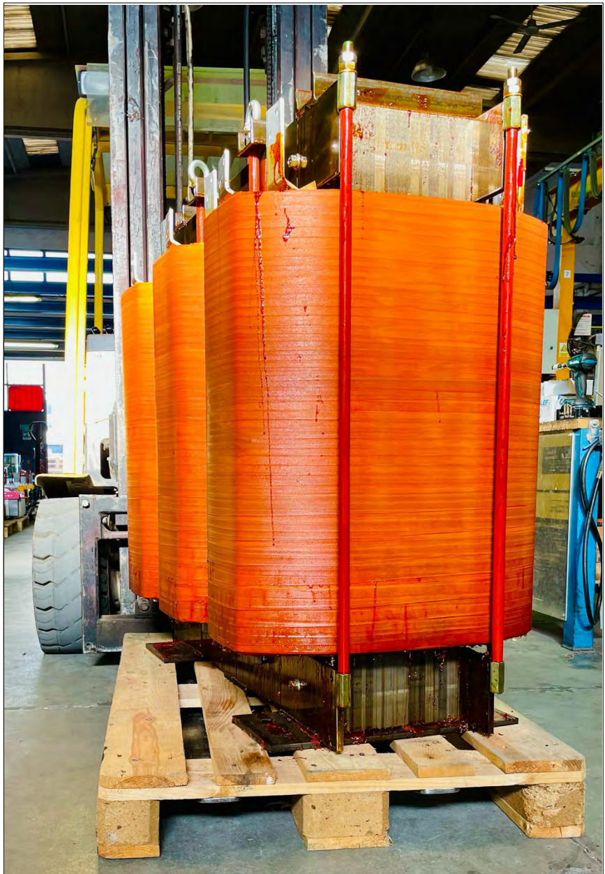
Trasformatori Doppio Isolamento con pastiche Termiche Bimetallo Double Insulated Transformers with Bimetal Thermal Pads
