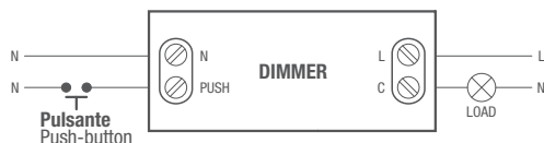
Collegamento del Pulsante sul NEUTRO Push-button connection on the NEUTRAL
